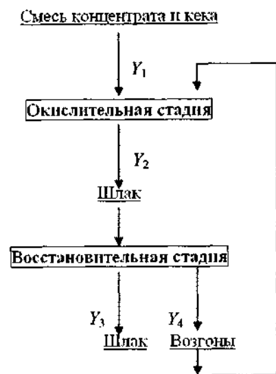
Рис. 1.14. Схема потоков цинка ( Y_i ) в процессе Ванюкова
